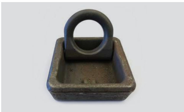
Exempel på typiskt surrningsfäste på ett fordon inregistrerat före april 2009 som har en säker belastning på 2 ton.
