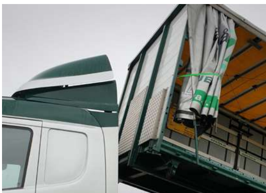
Typiskt slagprovad framstamskonstruktion.
