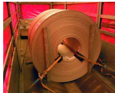
Exempel på rulle i fast vaggå förstängd med stöttor.
