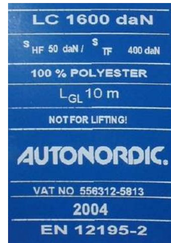
Exempel på märkning av spännband enligt EN 12195-2.
